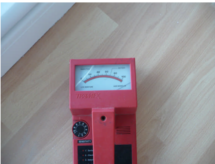
19. Off scale 100 moisture content
